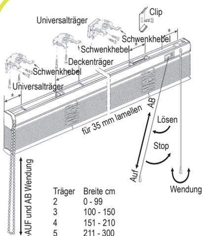
\* **Achtung:** keine Träger in diesen Bereich montieren. Träger immer nahe am Bedienelement montieren.
