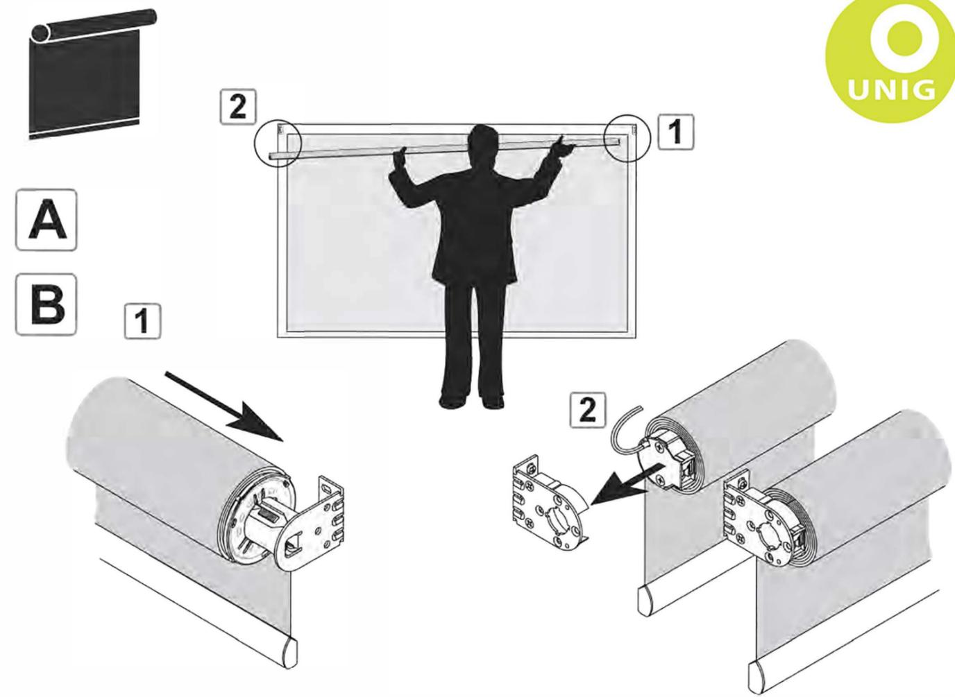
Das Kabel montieren und die Elektrizität anschließen wie in der Anleitung für den Motor angegeben.
