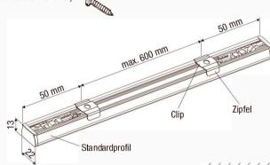
Achtung: Wir empfehlen, dass Sie den Clip mit dem Zipfel nach vorne (in den Raum) montieren. Der Clip lässt sich nur mit dem Zipfel gegen das Fenster montieren, wenn der Abstand zur Schiene min. 7 mm ist.
