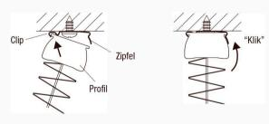
Bei Demontage den Zipfel des Clips nach oben drücken, so dass das Profil aus dem Clip ausgenommen werden kann.
