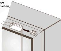
Die unteren Bodenbeschläge aus der Schiene ausnehmen und sie über die Montageplatten schieben, bis sie einklicken.
