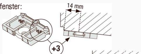
Der Profilabstand zur Vorderkante des Fensters muss 3 mm sein (Lochabstand 14 mm). Die Montageschablone mit der Markierung "+3" bei der Vorderkante legen.
