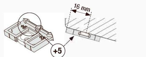
Der Profilabstand zur Vorderkante des Fensters muss 5 mm sein (Lochabstand 16 mm). Die Montageschablone mit der Markierung "+5" bei der Vorderkante legen.
