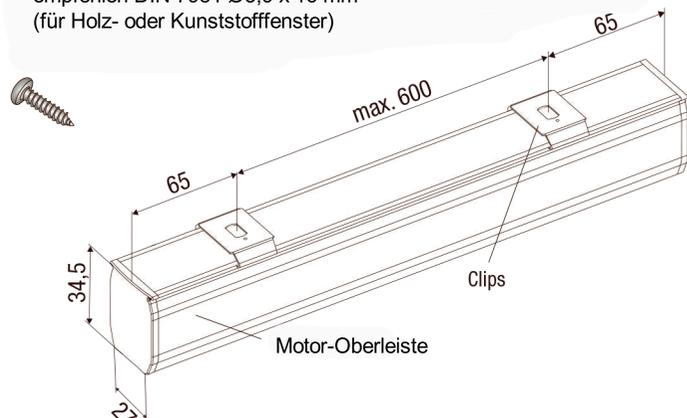
**Montage:** Das Profil in die hintere Kante des Clips anbringen, und die vordere Kante des Profils nach oben drücken, (bis es einklickt).
