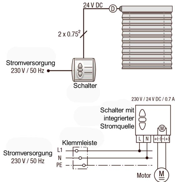
Einzelsteuerung mit Schalter und Transformator mit Stecker
