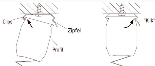
Bei **Demontage** den Zipfel des Clips nach oben drücken, so dass das Profil aus dem Clip ausgenommen werden kann.
